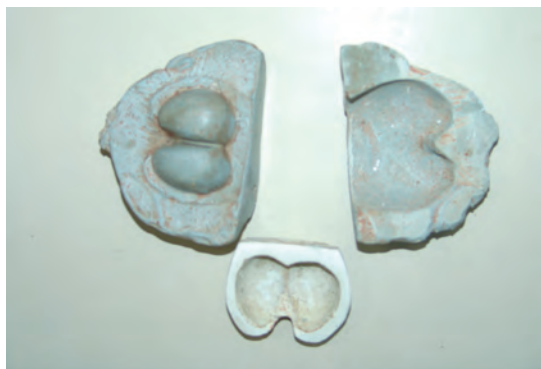
Figura 2 - Molde de massa plástica em duas partes e modelo de gesso
